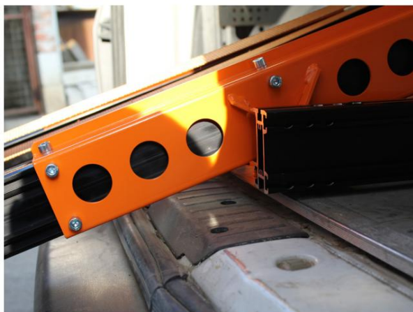
3. アクセスランプを再度展開します。バンのバンパー等との隙間が 10mm程度になるように調整してください。
